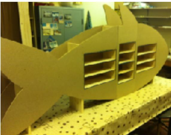
Dann wird alles wieder umgedreht, so dass ich die Fronten oben auf die Bretter legen konnte. Nun habe ich mit einem 2mm Bohrer dort vorgebohrt, wo ich die Fichtenbretter mit der Front verbinden konnte und sie mit den Torx-Schrauben befestigt.
